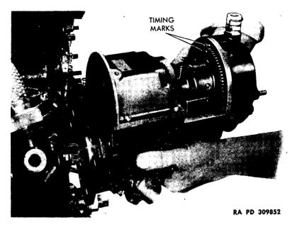
Figure 151 — Installing Magneto (Bosch)
